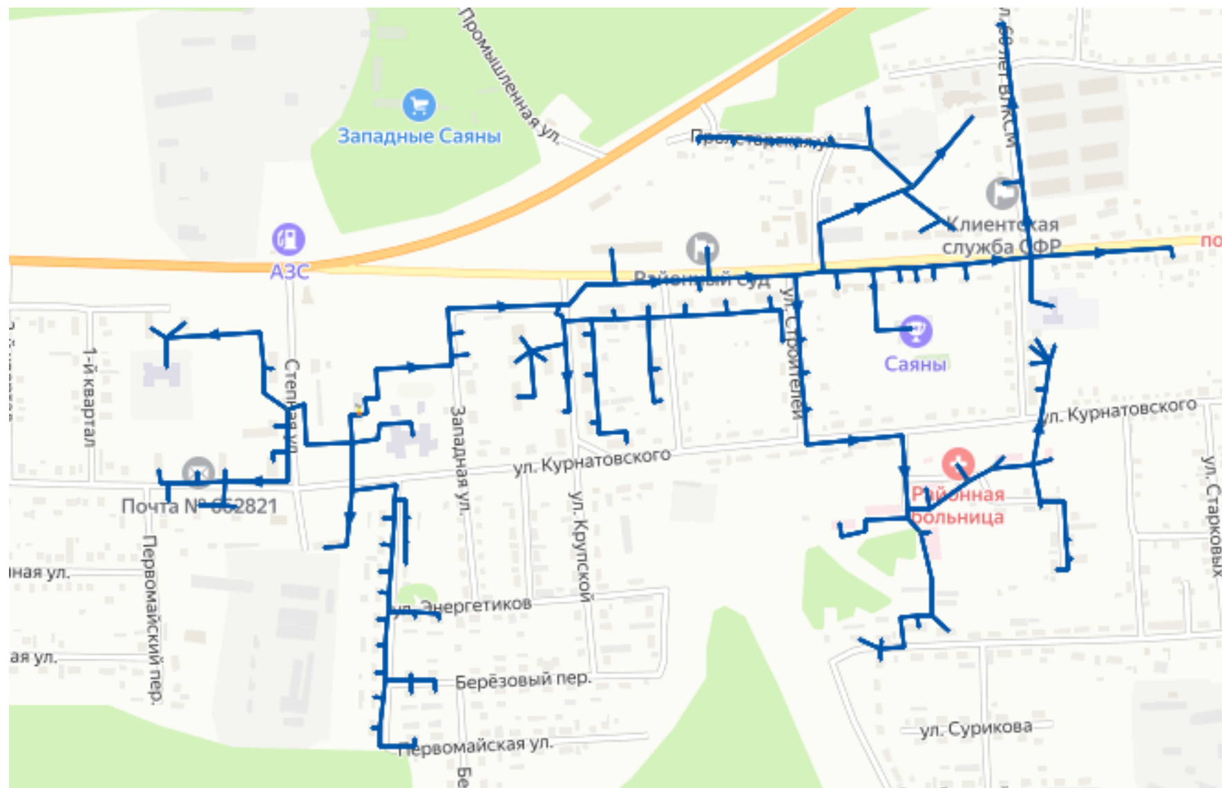
1.3.2.3 Схема тепловой сети от источника тепловой энергии Котельная «Дом детства»
